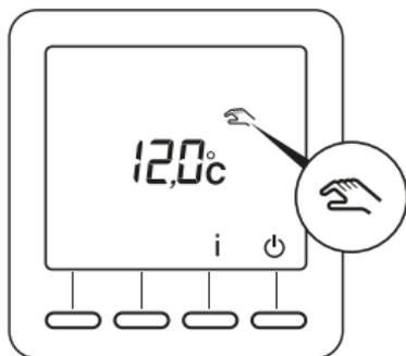
Sollte bei einer externen Programmunterbrechung das Symbol
