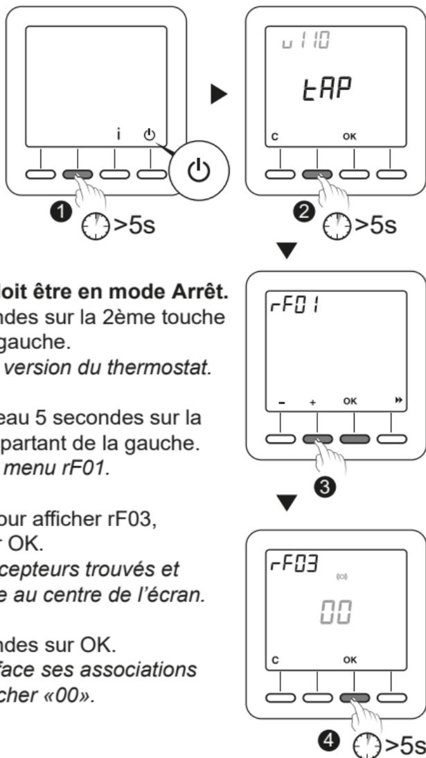
É **Le thermostat doit être en mode Arrêt.**
